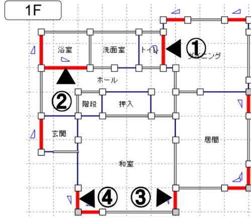
凡例 — 一般壁    ≡ 開口部    — 耐力壁    ▲ 筋かい
