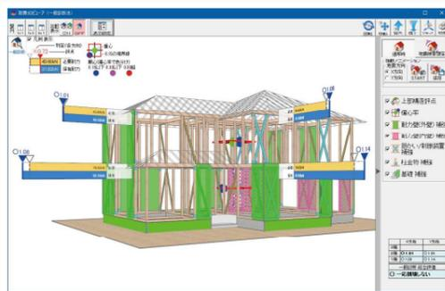
一般診断法や精密診断法の上り構造評点や耐力壁補強、柱金物補強箇所を3Dで可視化します。建物の耐震性能をより直感的に認識できます。
