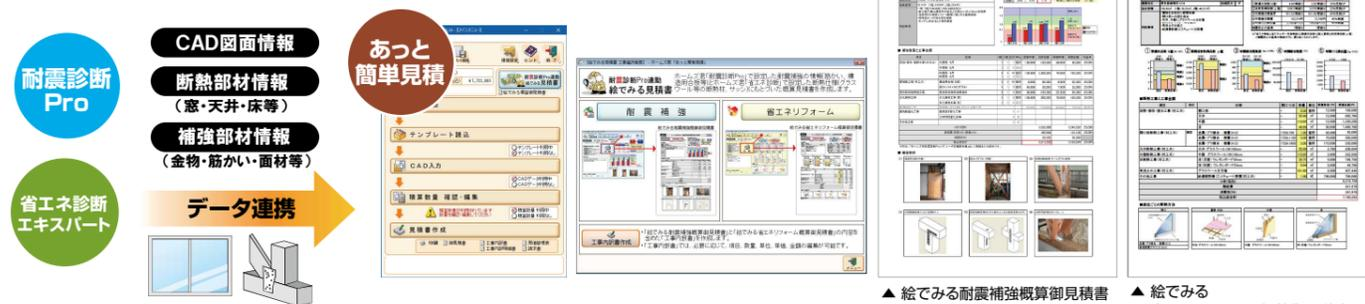
ホームズ君「あっと簡単見積」は、木造住宅に特化した、新築・リフォームを問わず幅広く活用できる建築見積ソフトウェアです。屋根面積や外壁面積をはじめ、金物や筋かいなど補強部材情報や、窓などの断熱部材のデータ連携により、詳細な数量拾いが可能です。部屋別の内装数量(床、壁、廻り縁)などの数量も自動で拾われ、とても便利です。3D表示機能やリアルな外壁材・屋根材表示機能などのプレゼンテーション機能もあり、見積書作成のみならず総合的な営業支援ツールとしてお使いいただけます。「絵でみる耐震補強概算御見積書」や自治体の推奨事例を参考にした耐震補強用のテンプレートなど、耐震補強工事の見積書作成のための便利な機能が充実しています。
