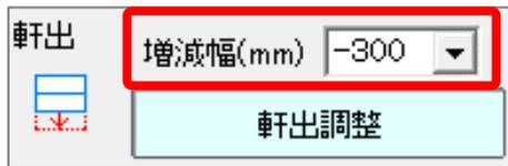
STEP2 2階の切妻屋根の軒出（ケラバの出）を調整する
