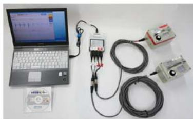
建物の常時微動を計測し、計測結果より求められた固有振動数をもとに、耐震性を客観的に評価することが可能です。耐震改修工事の前後に計測することで、改修効果をアピールできます。
