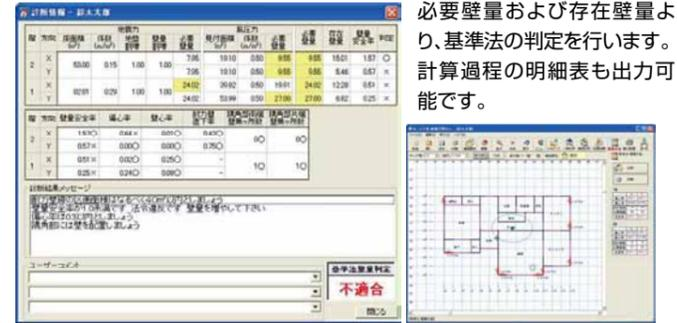
必要壁量および存在壁量より、基準法の判定を行います。計算過程の明細表も出力可能です。
