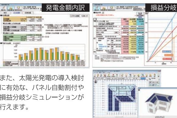
また、太陽光発電の導入検討に有効な、パネル自動割付や損益分岐シミュレーションが行えます。
