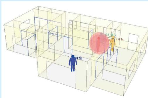
いままでの平面的な動線アニメーションのほかに、3D動線アニメーションを新機能として搭載。人と人が「かちあう」(例:廊下ですれ違う、洗面所で鉢合わせする)可能性がある箇所は赤い丸印で示され、家のどの部分が混み合うかが一目わかります。
