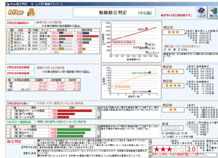
動線長さ、かちあい回数、部屋使用時間、ドア開閉回数、収納率の個々の項目について、評価を行います。それらの評価をもとに、総合判定として、1点～5点の5段階判定を行います。
